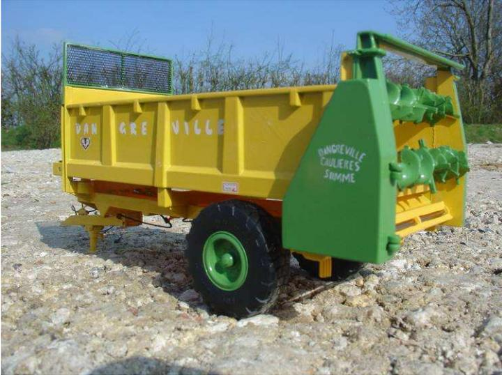
Réalisé par ROS, le DC7000 est inspiré d'un modèle de 1972, équipé d'un hérisson avec 2 vis horizontales et d'un démêleur, avec tablier chaîne Vaucanson, d'une flèche avec suspension tampon, d'une béquille mécanique à manivelle, de roues 1400R20 Michelin.
