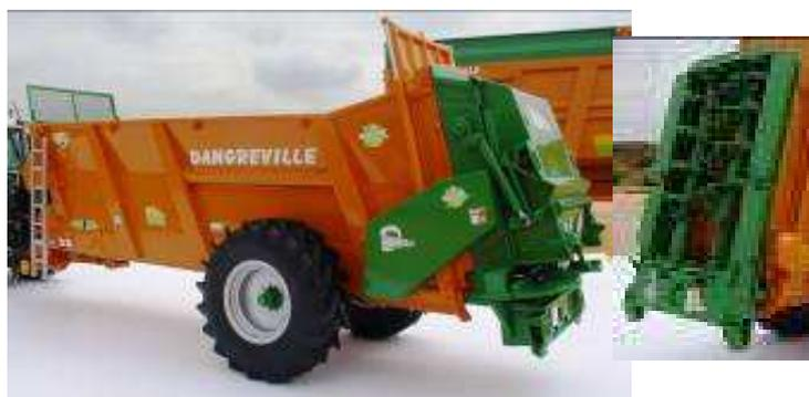
L'épandeur EVT11 simple essieu est équipé d'une table d'épandage avec hotte articulée (facilement démontable), d'une porte hydraulique, de 2 vis horizontales avec arbre, de roues Alliance 650/75R32. En option : le kit hérissos complet avec vis verticales muni d'une hotte. (Universal Hobbies)
