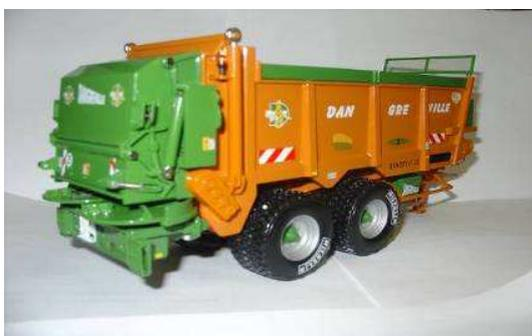
L'épandeur à table 2 essieux ETB15000 tandem avec équipements d'une table d'épandage avec hotte articulée, d'une porte hydraulique, roues Michelin 710/50R26.5, centrale hydraulique et DPAE (ROS)
