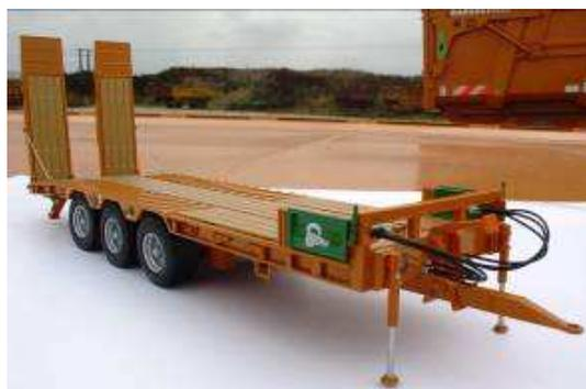
Le porte-engins PE32 en 3 essieux avec essieu suiveur arrière, est équipé de deux rampes hydrauliques, de deux béquilles avant et deux béquilles arrière hydrauliques, chaussé en roues 435/50R19.5 (Universal Hobbies)
